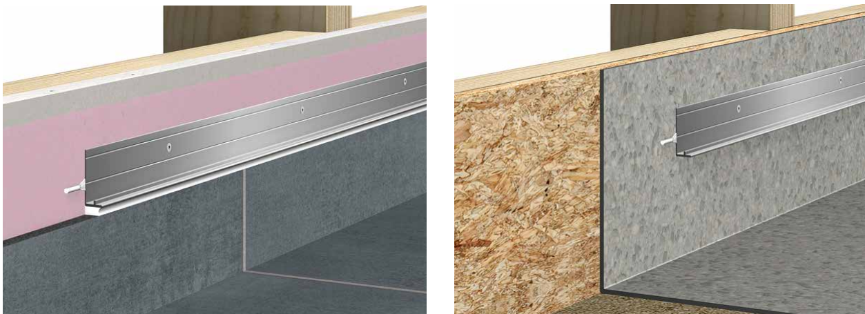
Fibo-seinälevy nostettuna 6–8 cm lattian yläpuolelle, seinän ja lattian välissä lattiapäällyste tai sokkelilaatta.
